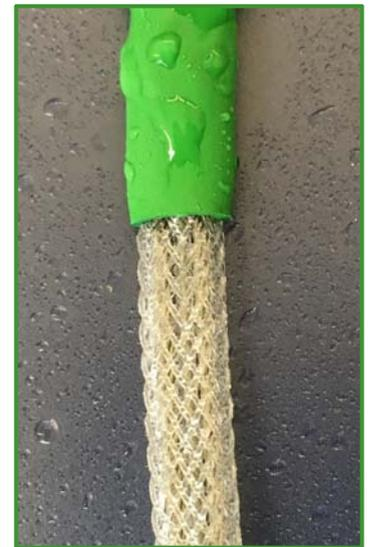
eine *erhöhte Toleranz gegenüber Betauung*. Der Sensor erhält somit nicht nur **größere Funktionsreserven**, sondern gleichzeitig besseren **Schutz vor mechanischer Belastung**. Unerwünschte Fehlalarme werden vermieden, erst die *vollständige Durchdringung* des Sensorkabels mit Wasser löst einen Alarm aus.
