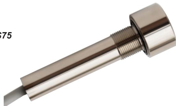
Der explosionsgeschützte Signalgeber vereint kleine Bauform (Befestigungsgewinde M16 x 1.5), eine geringe Stromaufnahme (nur 6 mA) und eine hohe Lautstärke (90 dBA im Abstand von 0.3 m).
