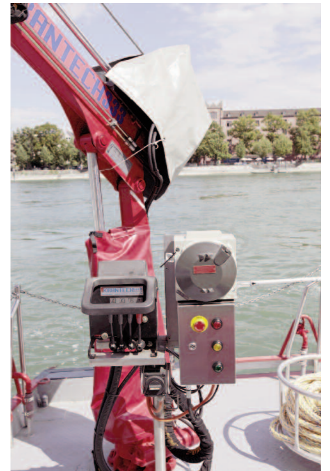
Abbildung: Kransteuerung Feuerlöschboot Basel-Stadt Image : Commande de la grue du bateau-pompe de la ville de Bâle Picture: Crane control of the Basel-City fireboat.
